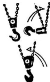
Рис. 6 - Неправильное положение крюка
